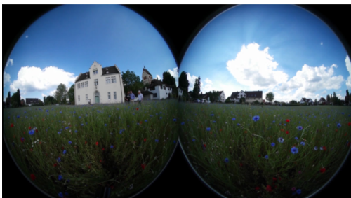
Ungestitchtes Videobild der zwei 180°-Fischaugen-Objektive einer 360°-Kamera
